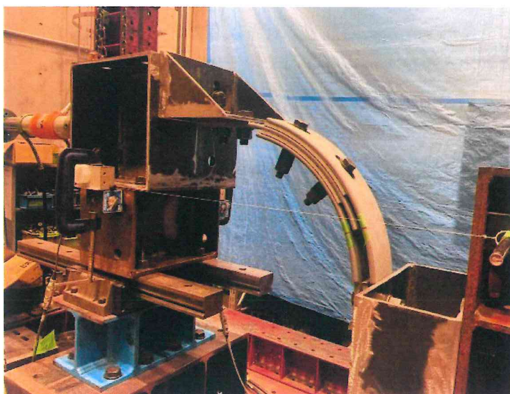
図 1.1.9 巻き取り式変位計の接続方法
